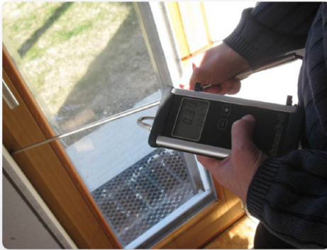
Odkrivanje netesnih mest z ročnim anemometrom
