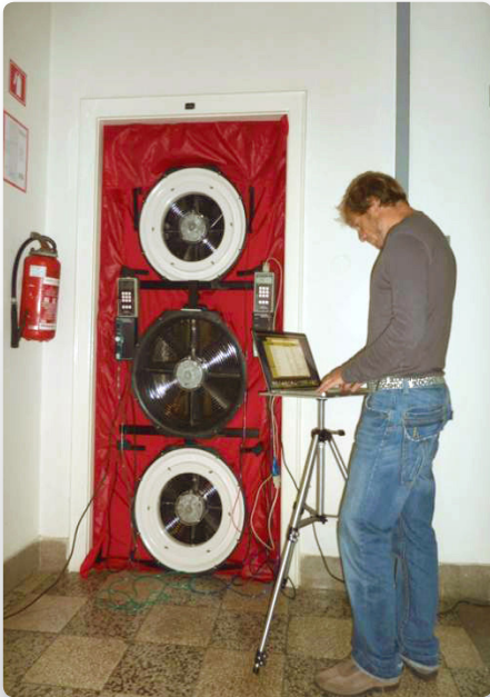
Oprema za test zrakotesnosti (Blower door)
